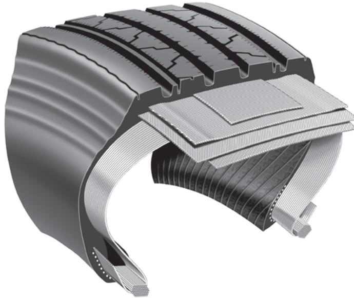
Las llantas radiales tienen cuerdas (las cuales pueden ser de nylon o acero) de lado a lado de forma ortogonal de acuerdo a la banda de rodadura. Las llantas radiales llevan ese nombre debido a que sus estructuras forman ángulos menores de  $90^\circ$  en dirección a los radios imaginarios de la rueda.
